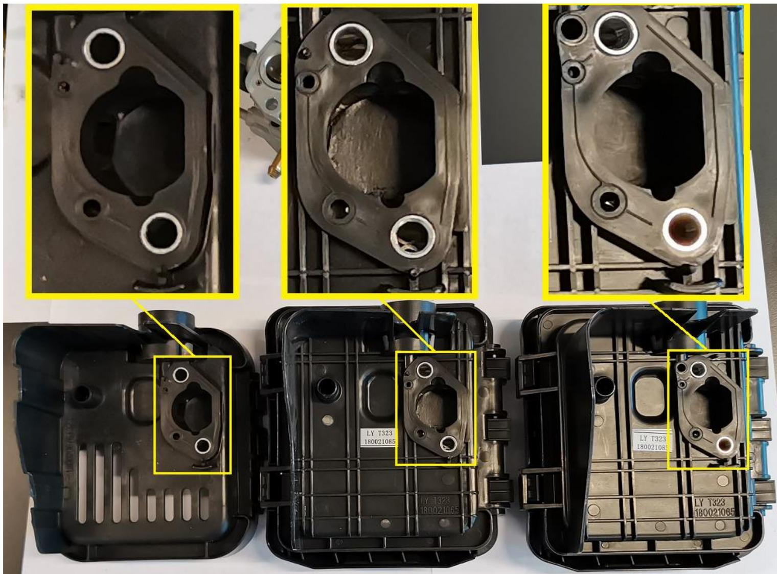
Первый корпус (180020732-0001) устанавливался до s/n 33042001001, использовался с поролоновыми фильтрами 180130250-0001 и 180130251-0001. В настоящий момент снят с производства, его рекомендуется заменять на корпус 180021165-0001 в сочетании с карбюратором 170022570-0001.
